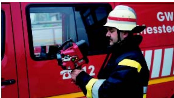
Hoch empfindlich: Die Thermal Imager (TI) der Fa. Bullard hat eine Auflösung von 0,05 °C. Das Einsatzspektrum der Kamera reicht von der Brandbekämpfung über die Menschenrettung bis hin zur Suche von Körperteilen nach Unfällen.
