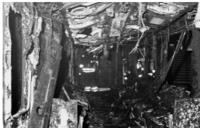
Innenansicht des zerstörten U-Bahn-Wagens.
