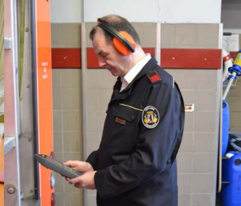
Lärmschutzmessung am Pumpenbedienstand Bild: Berliner Feuerwehr
