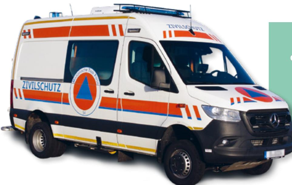
Die neue Generation der Krankentransportwagen Typ B ZS hat einen Allradantrieb sowie ein Schlechtwetterfahrwerk.
