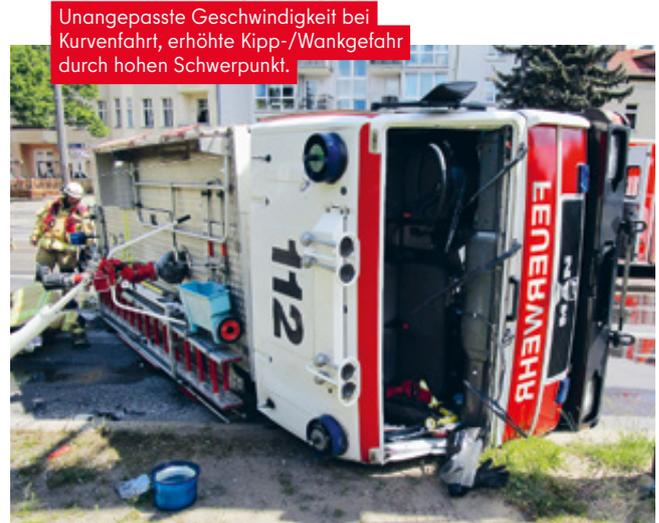
Unangepasste Geschwindigkeit bei Kurvenfahrt, erhöhte Kipp-/Wankgefahr durch hohen Schwerpunkt.
