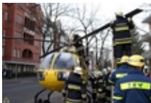
Ein Rotorblatt wird angeschraubt
